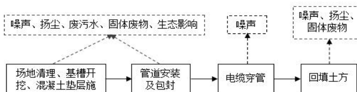
图 2.2 本项目电缆施工工艺流程示意图
