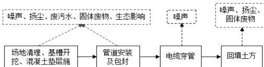
图 2.2 本项目电缆施工工艺流程示意图
