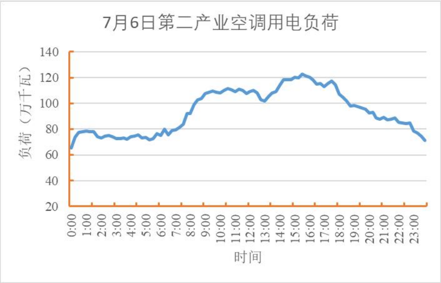
图 5.6 7 月 6 日第二产业空调负荷日内变化曲线
