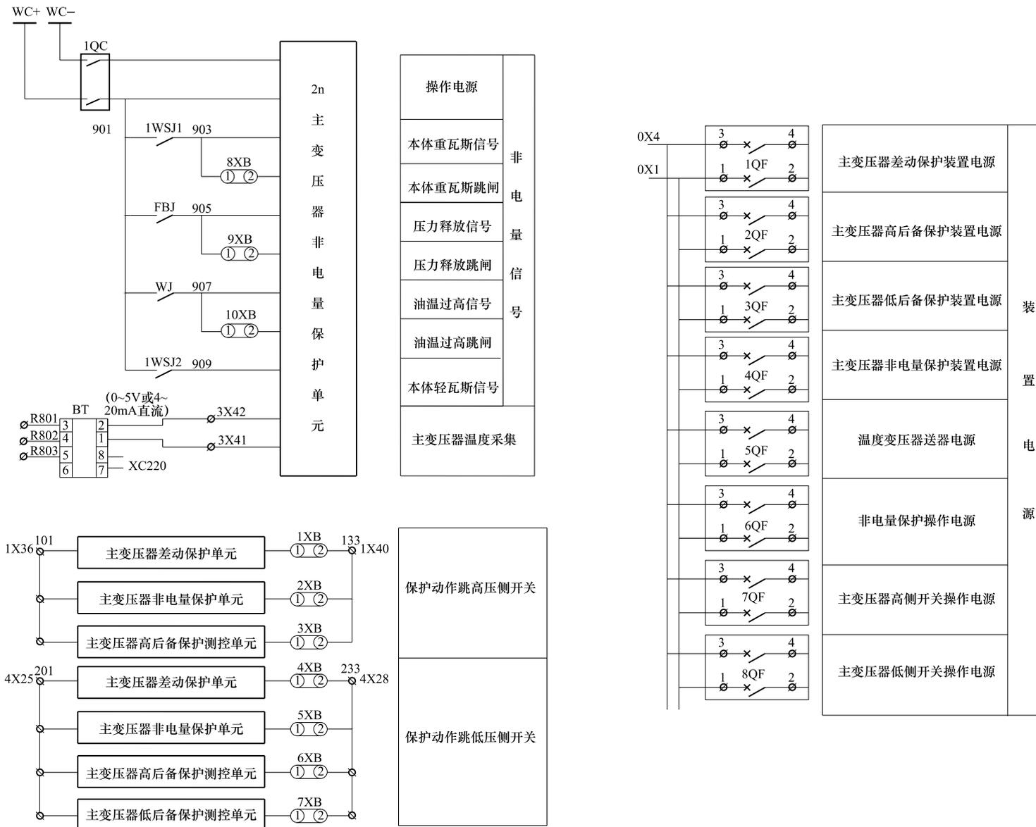
图 6-6 35kV 主变压器（差动保护）二次图——主变非电量保护及主变保护屏电源回路图
