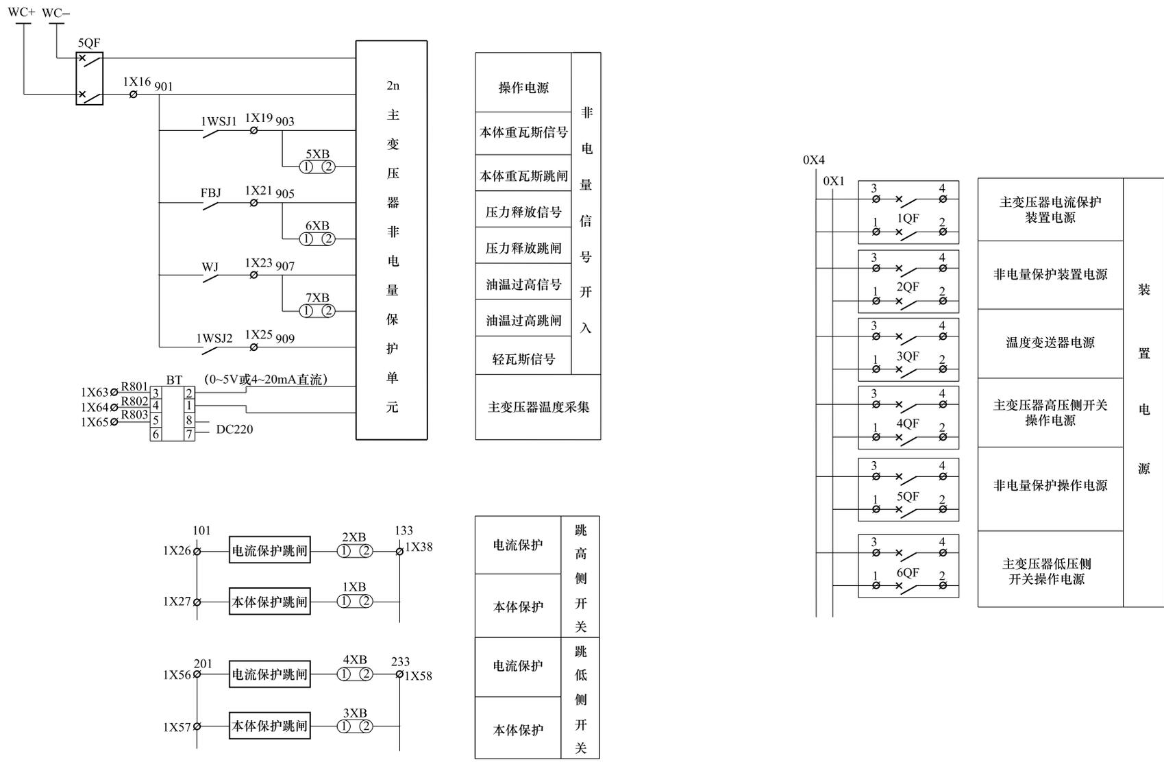
图 6-11 35kV 主变压器（电流保护）二次图——主变压器非电量保护及主变压器保护屏电源回路图
