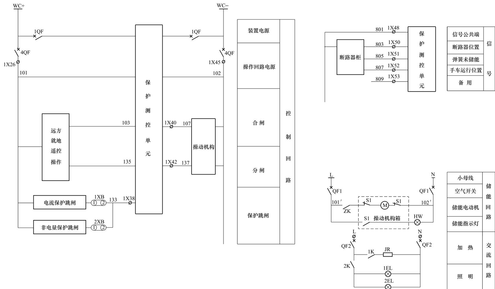
图 6-12 35kV 主变压器（电流保护）二次图——主变压器 35kV 侧开关控制信号回路图
