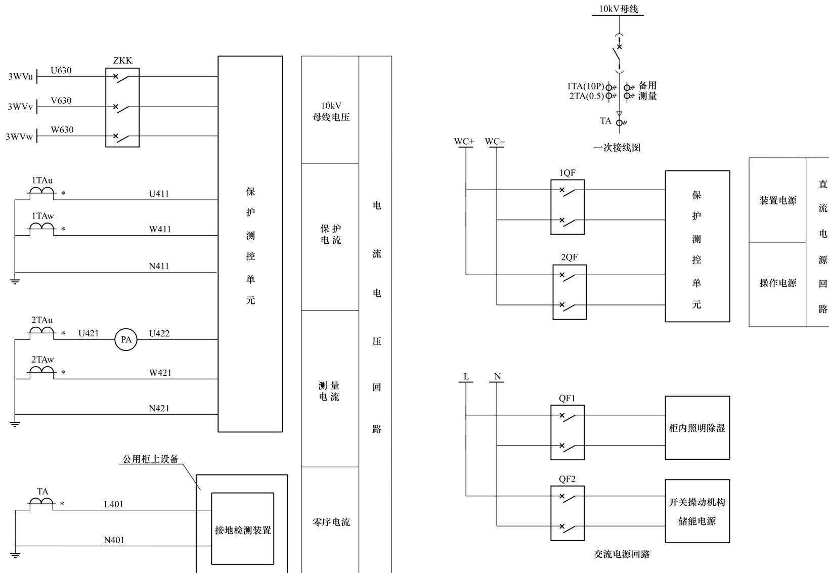
图 6-17 10kV 出线电流电压回路图
