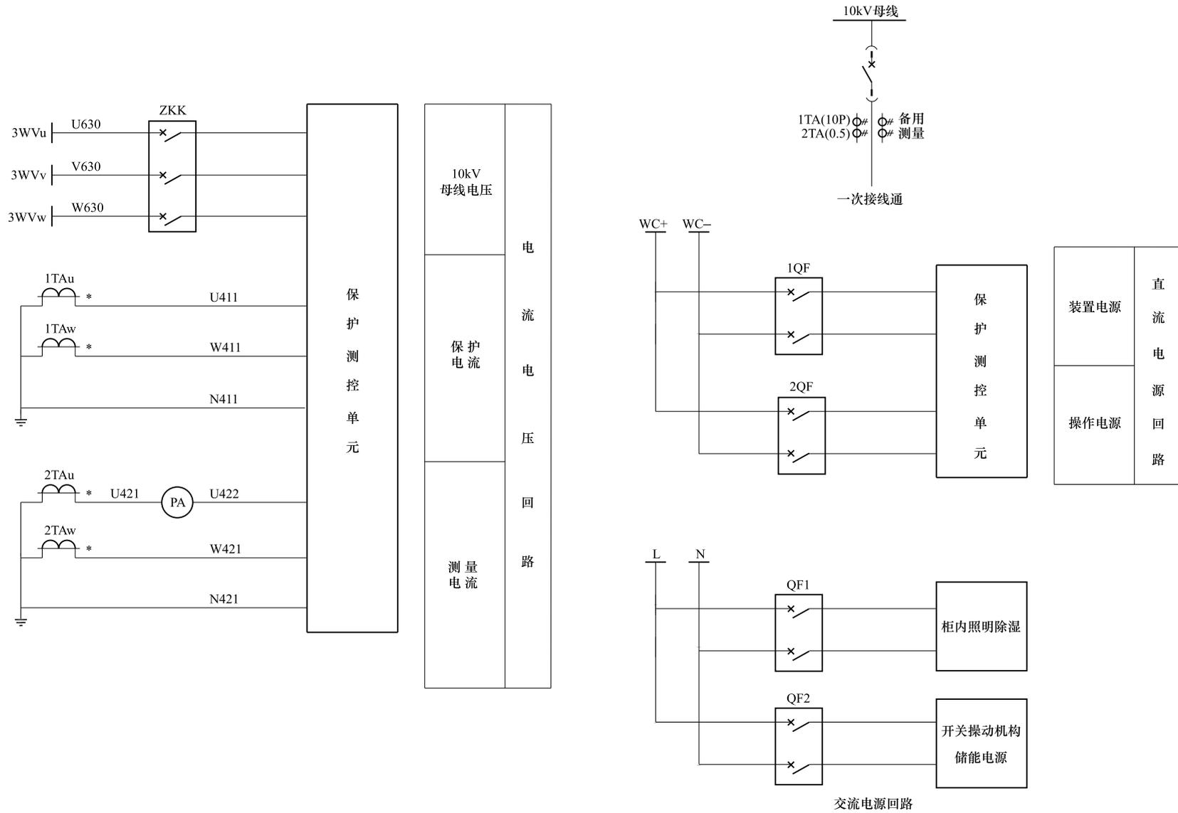
图 6-15 10kV 电源进线电流电压回路图
