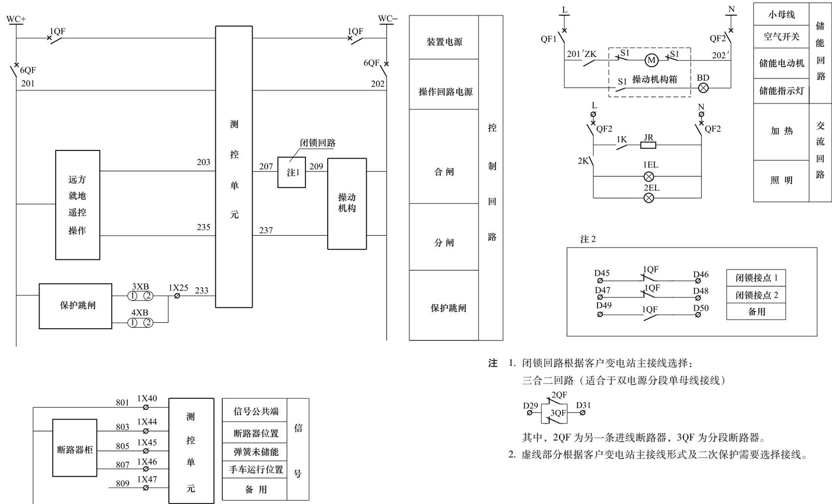
图 6-14 35kV 主变压器（电流保护）二次图——主变压器 10kV 次总开关控制信号回路图
