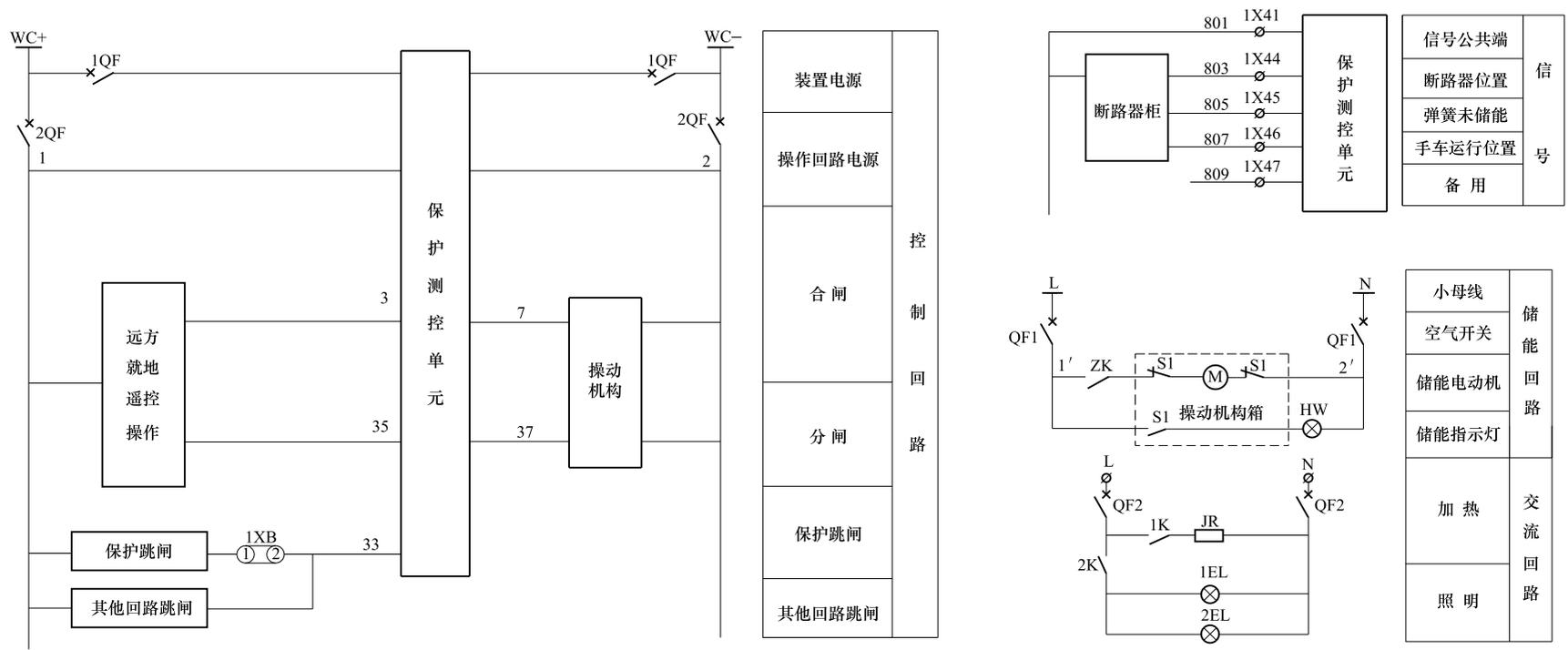
图 6-18 10kV 出线开关控制信号回路图
