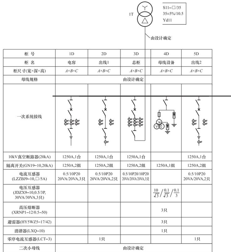
图 2-4 主变压器及 10kV 侧单母线固定柜油浸式变压器一次图
