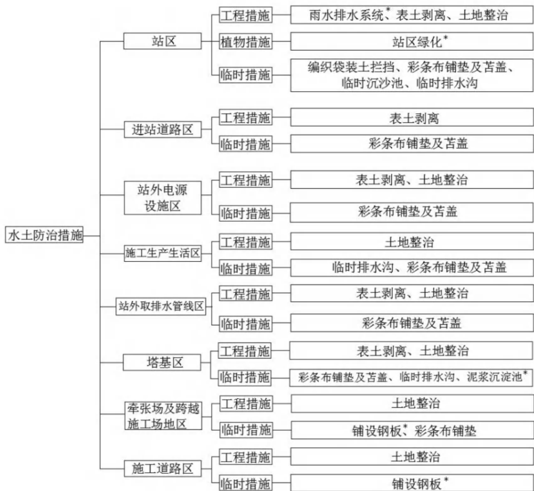
图 1-1 水保方案确定的工程水土流失防治措施体系图
