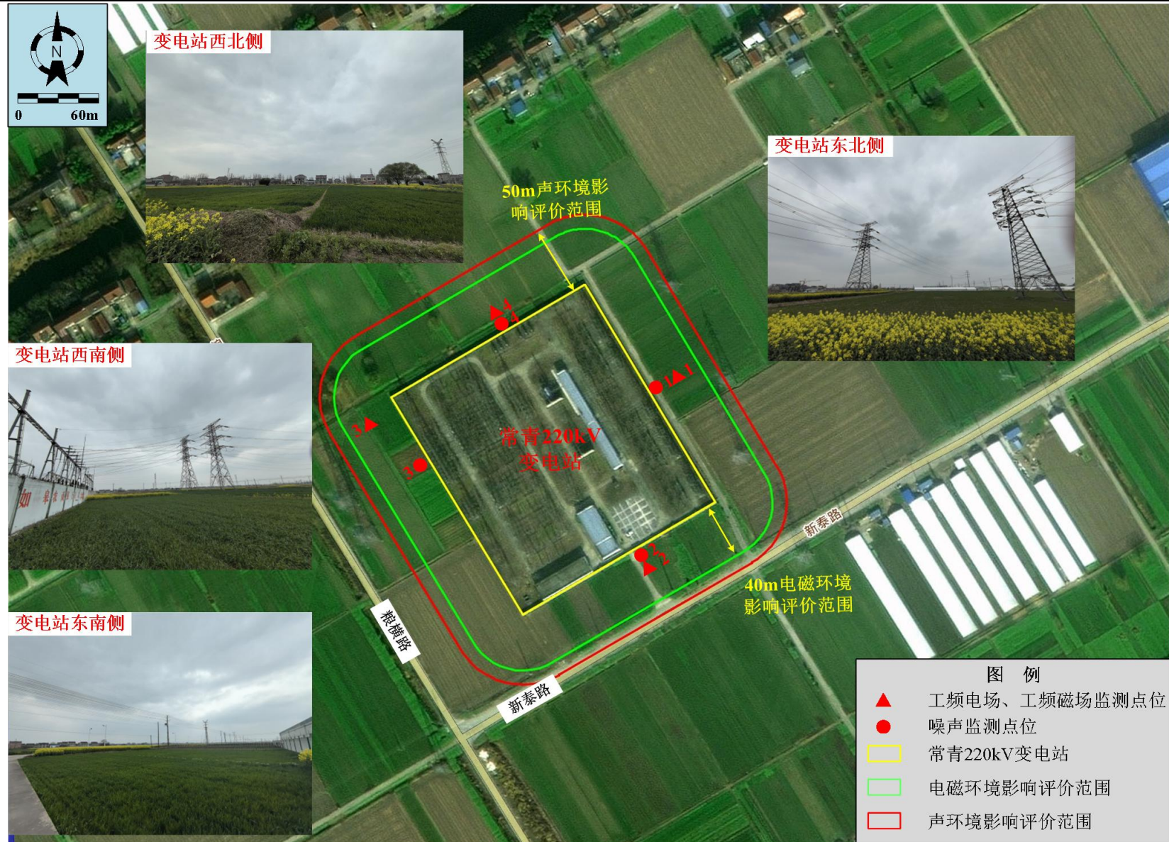
附图2 常青 220kV 变电站周围环境及监测点位示意图
