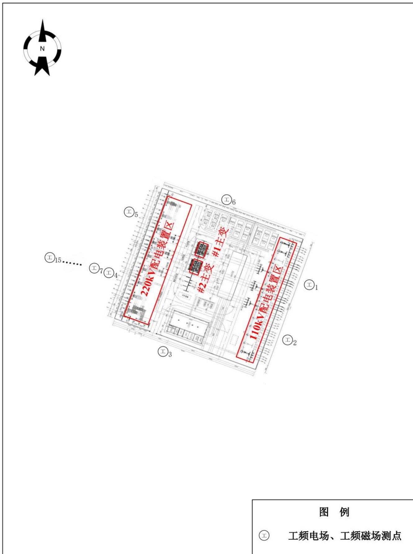
附图 7 类比变电站（汪圩 220kV 变电站）监测点位示意图
