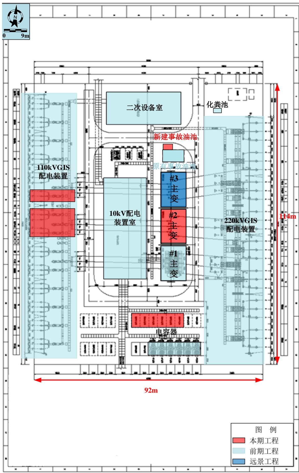
附图 3 壮志 220kV 变电站总平面布置示意图
