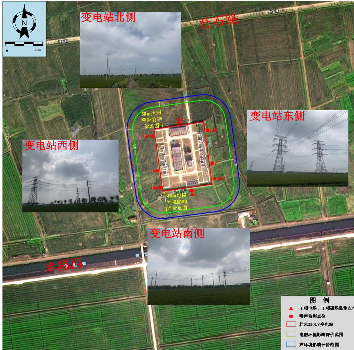
附图 2 壮志 220kV 变电站周围环境及监测点位示意图
