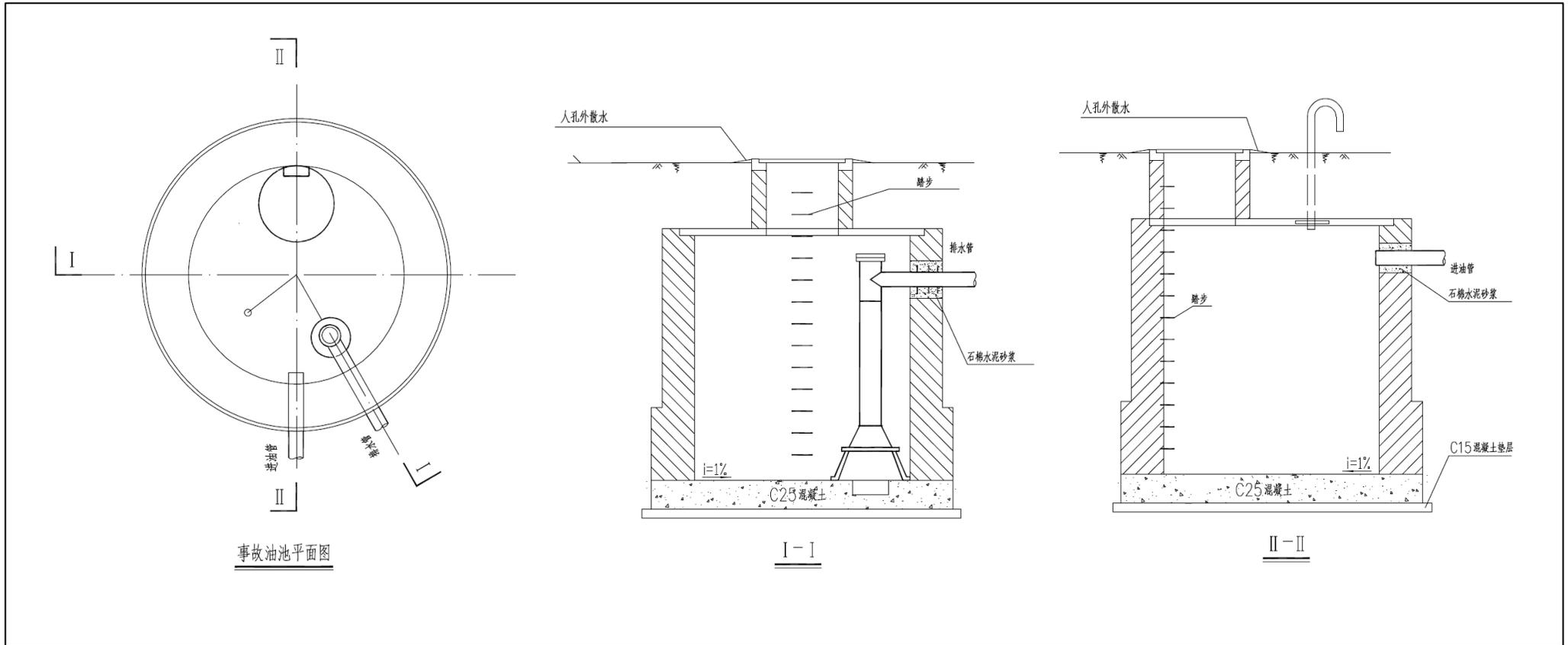
附图 5-2 本项目生态环境保护典型措施设计示意图（变电站事故油池）
