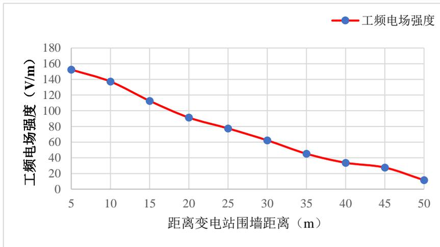
图 3-1 断面测点处工频电场强度趋势图
