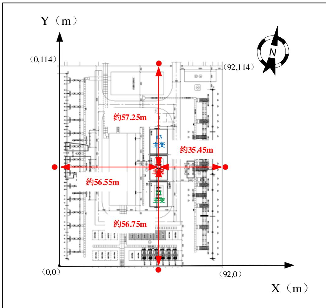
图 4-1 壮志 220kV 变电站周围声环境坐标示意图
