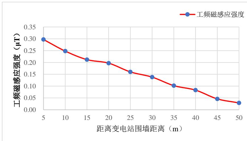
图 3-2 断面测点处工频磁感应强度趋势图
