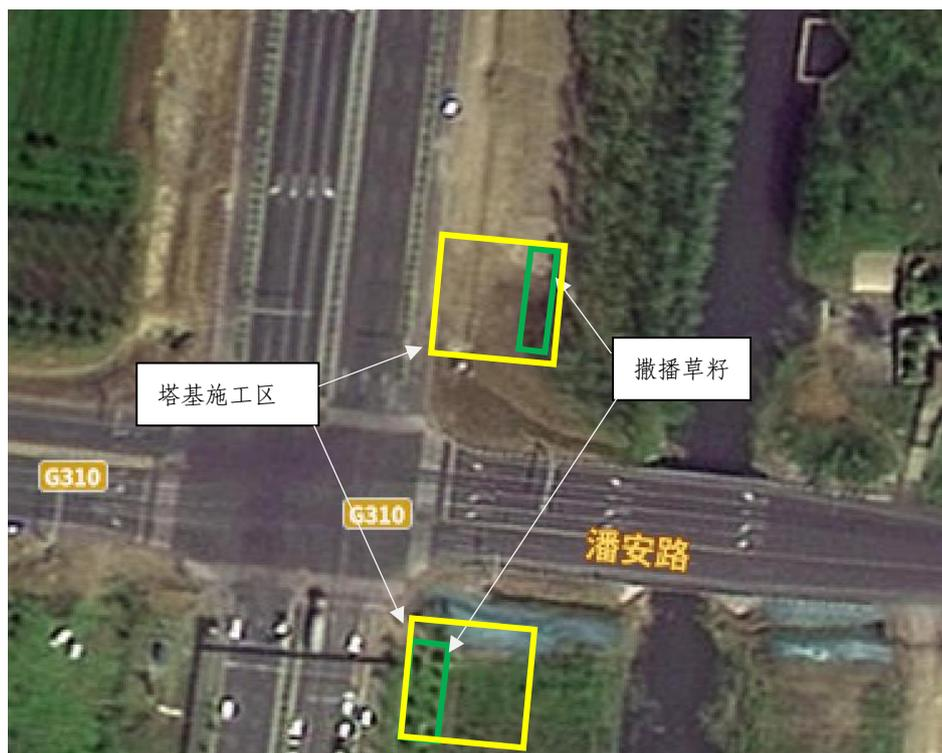
图 4.2.1 塔基施工区植物措施实施情况
