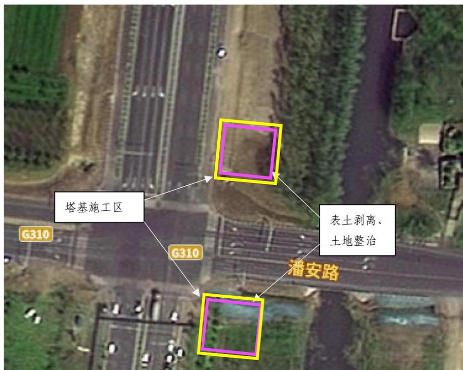
图 4.1.1 塔基施工区工程措施实施情况
