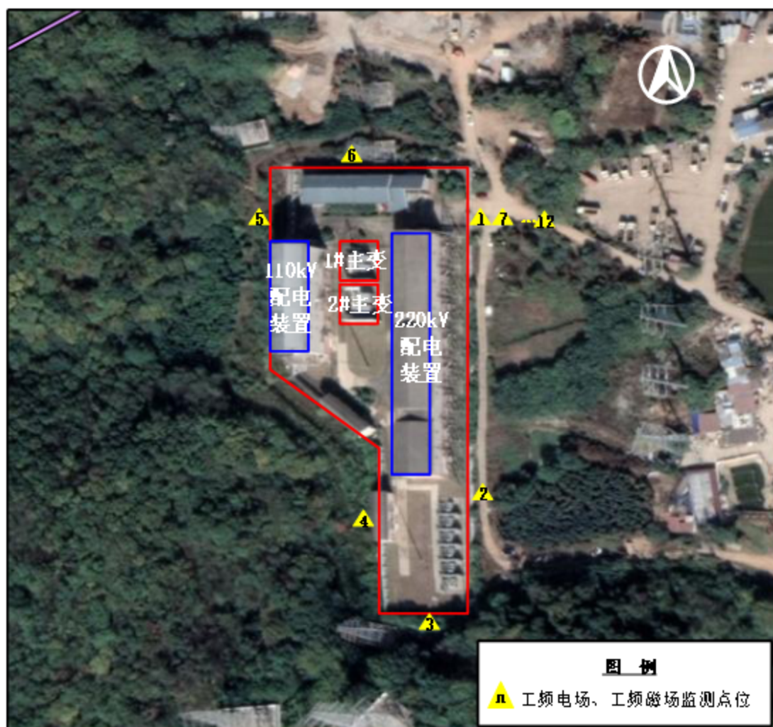
图 3.3-1 南京 220kV 仙鹤变电站（类比站）平面布置及监测点位示意图
