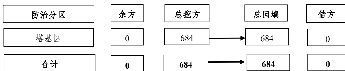
图 1.1-4 土石方平衡流向框图 单位：m 3
