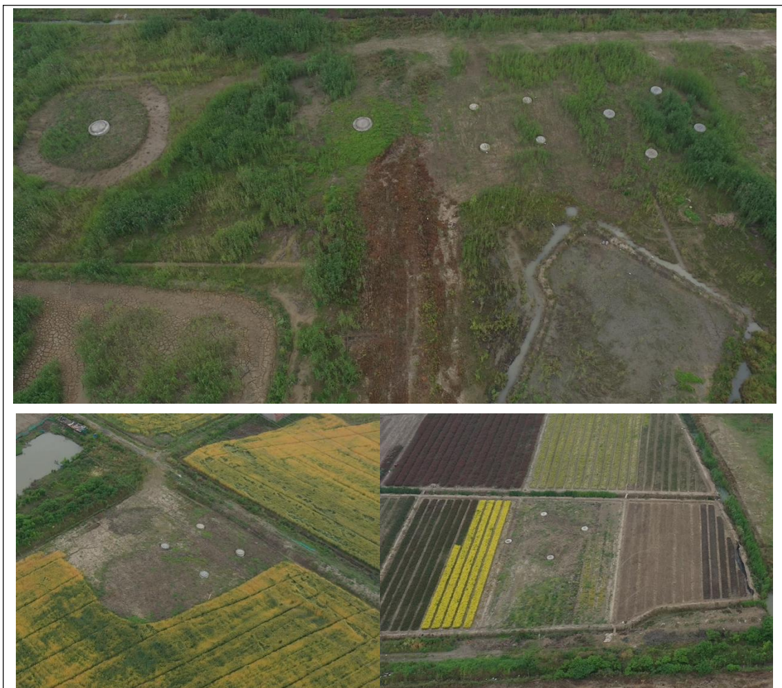
部分塔基施工场地部分区域已完成植被恢复,但仍需对其余基础施工塔基施工场地裸露地表及临时施工道路裸露地表采取苫盖措施。
