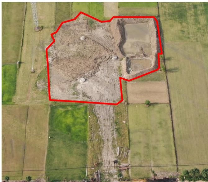
N6 塔基及塔基施工区扰动面积解译图-10月
