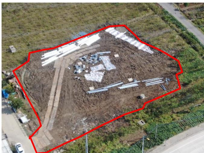
ET2 塔基及塔基施工区扰动面积解译图-10月
