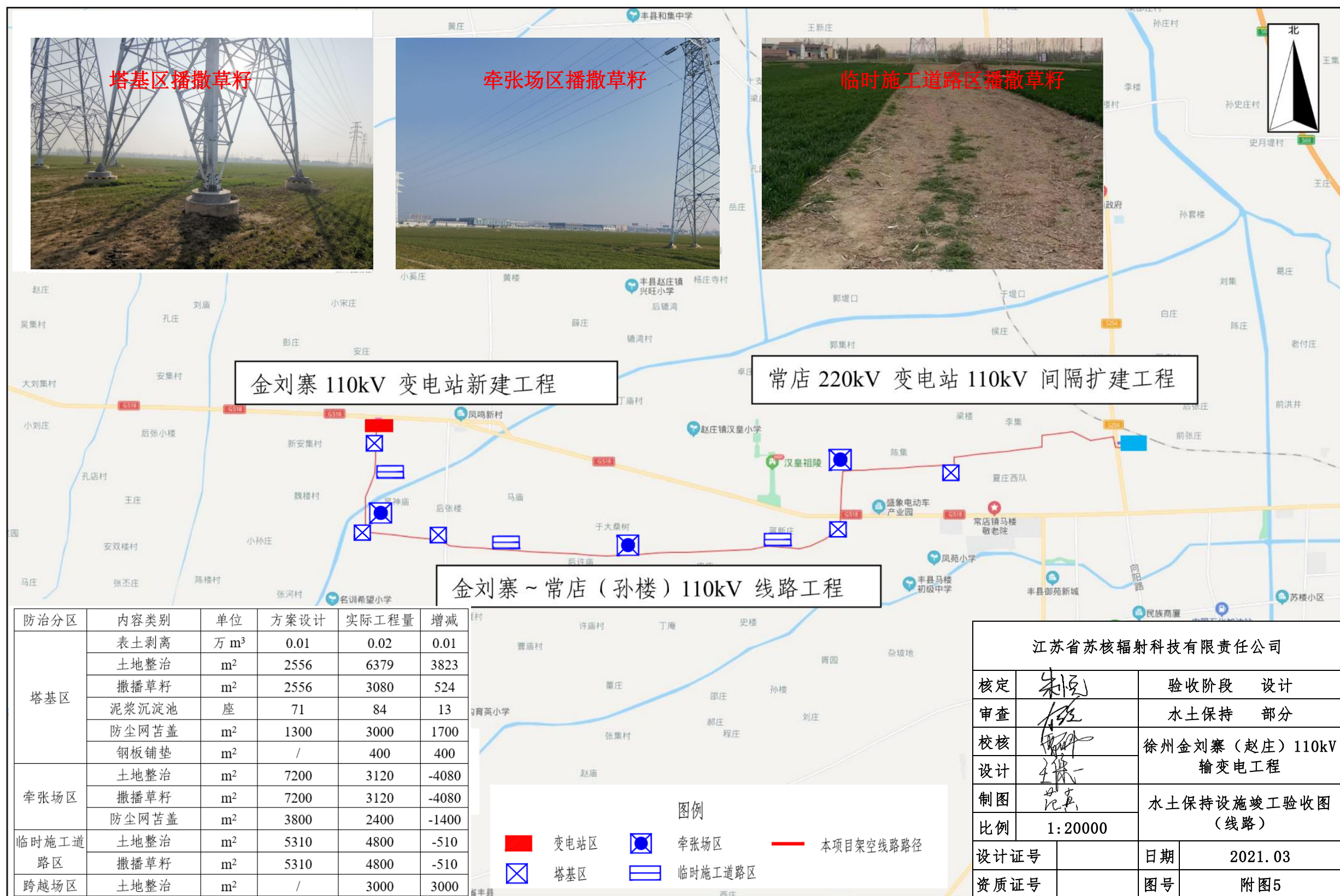
附图 5 水土保持设施竣工验收图（线路）
