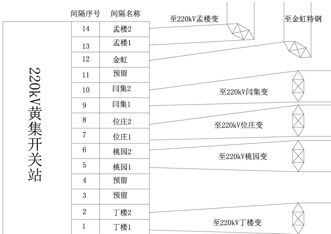
图1 220kV 黄集开关站现状 220kV 出线间隔示意图
