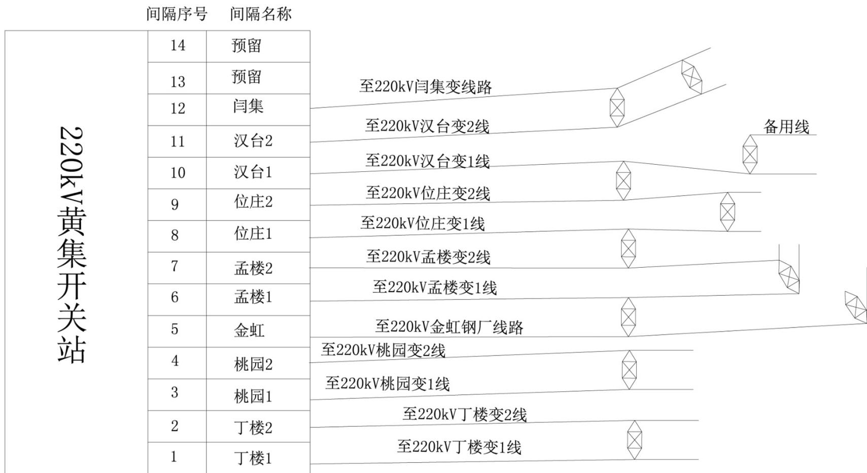
图3 本工程建成后，220kV黄集开关站220kV出线间隔示意图
