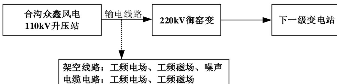
图 1 本工程 110kV 输电线路工艺流程及产污环节示意图
