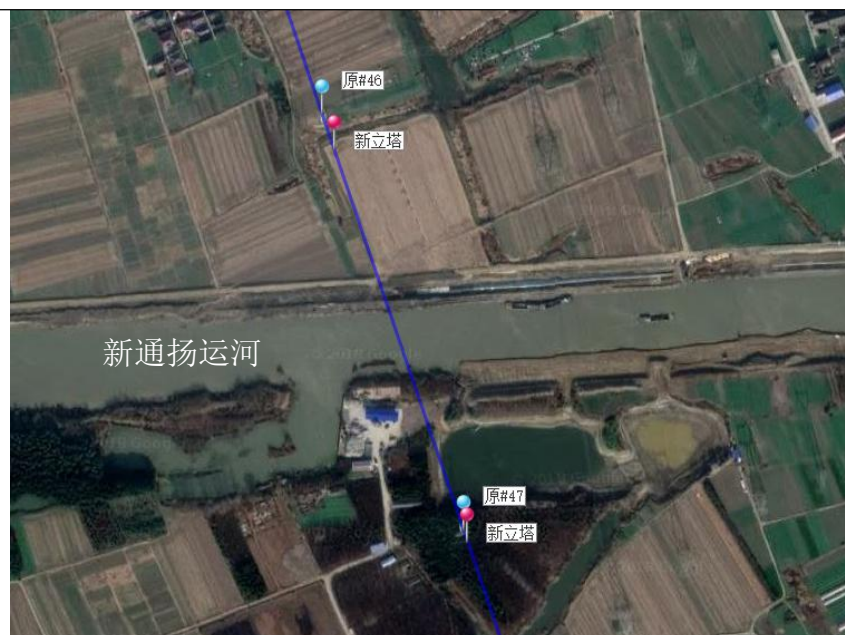
图 1-1 跨越新通扬运河处升高改造
