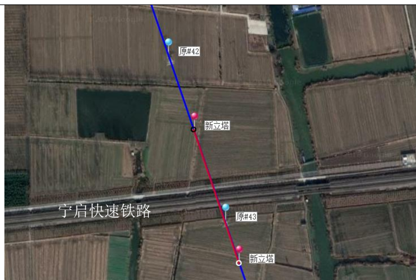
图 1-3 宁启快速铁路三跨改造示意图
