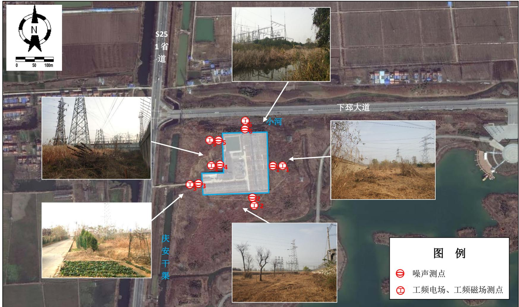
附图 2 庆安 220kV 变电站检测点位及周围环境示意图
