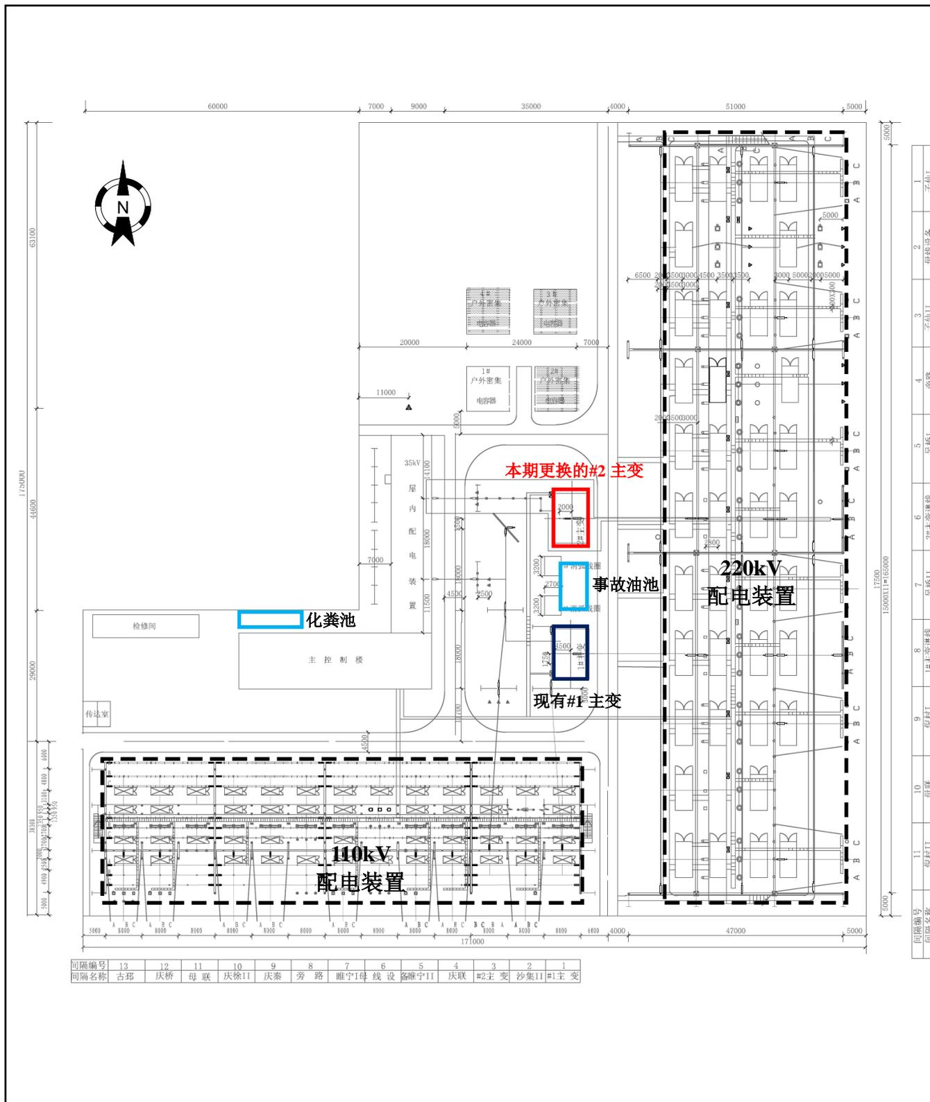
附图 3 庆安 220kV 变电站平面布置图
