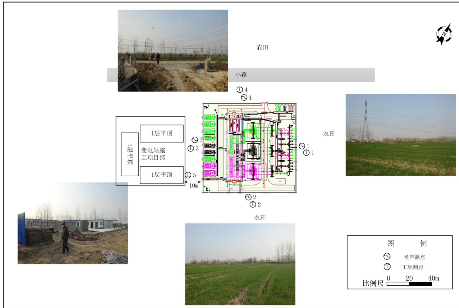
附图 2 110kV 城头变电站监测点位及周围环境示意图
