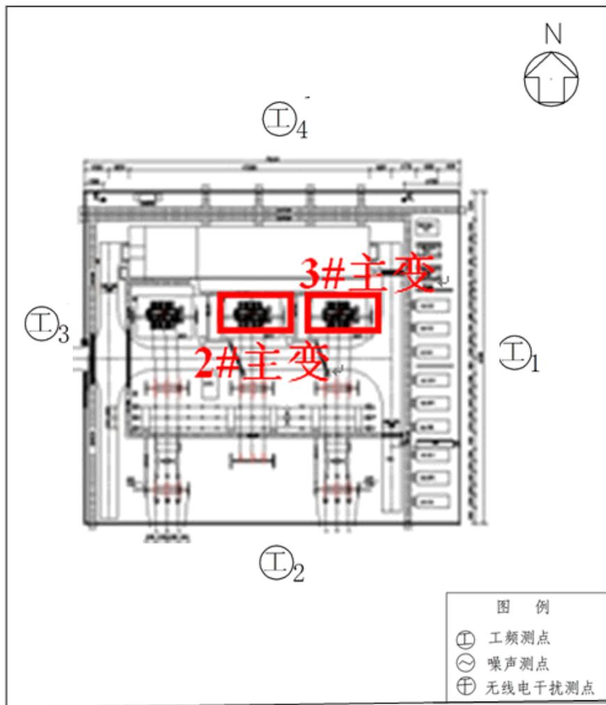
附图 8、110kV 元竹变电站（类比站）监测点位示意图
