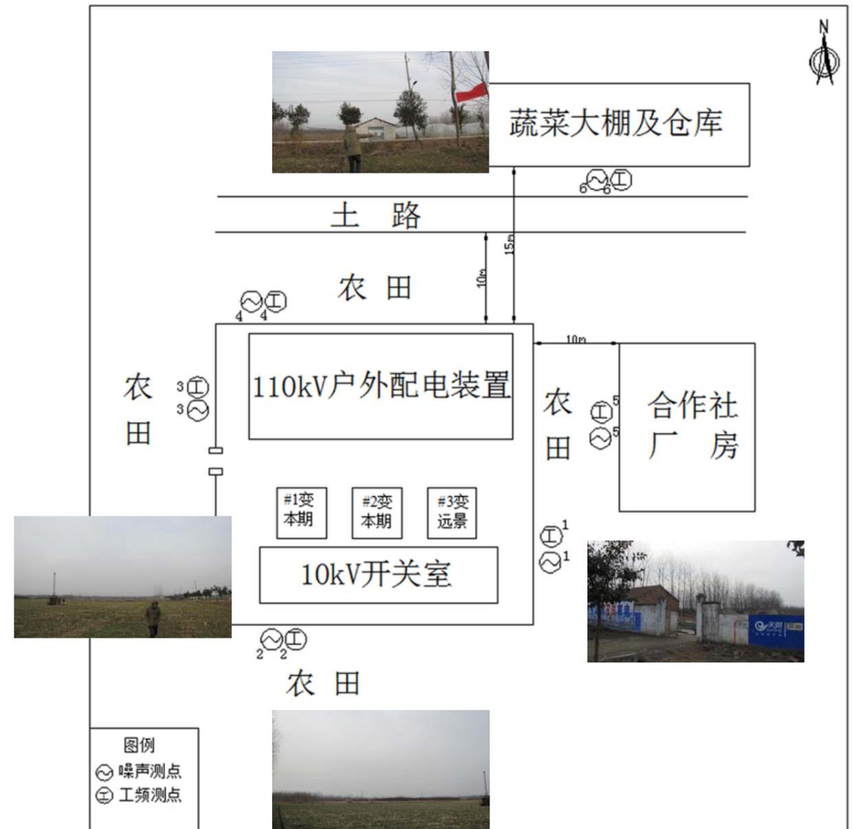
附图 2、110kV 三庄变平面布置示意图
