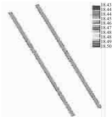
图7 绝缘拉板 Mises 应力分布云图
