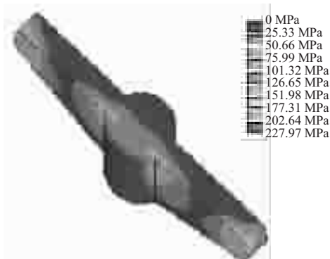
图6 后卡 Mises 应力分布云图
