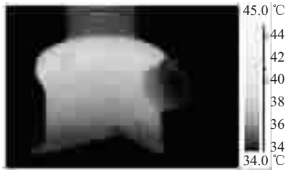
图 3 电压互感器油箱发热
