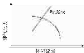
图 1 离心空心机进口压力恒定时流量压力特性曲线
